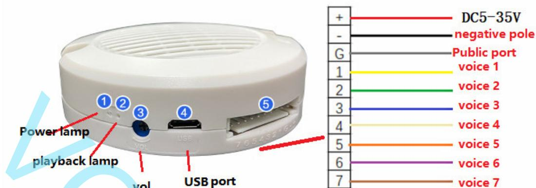
Воспроизведение включается замыканием соответствующего входа с серым проводом (G)
